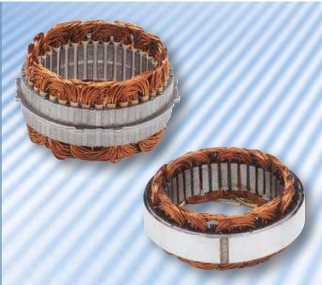
En el estator es producida la corriente eléctrica. Las bobinas de hilos de cobre son fijadas sobre un núcleo hecho de acero. Las bobinas del estator Bosch son construidas de forma a aprovechar al máximo la producción de corriente, son aisladas entre sí y cubiertas por barniz especial para resistir a las más altas temperaturas y entrada de residuos.
